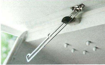
HEBELUK Der große Deckel über dem Niedergang lässt sich in drei Stellungen arretieren
