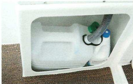
WASSERKANISTER Die Speicher für Frisch- und Abwasser sind nicht fixiert und dichten nicht komplett ab
